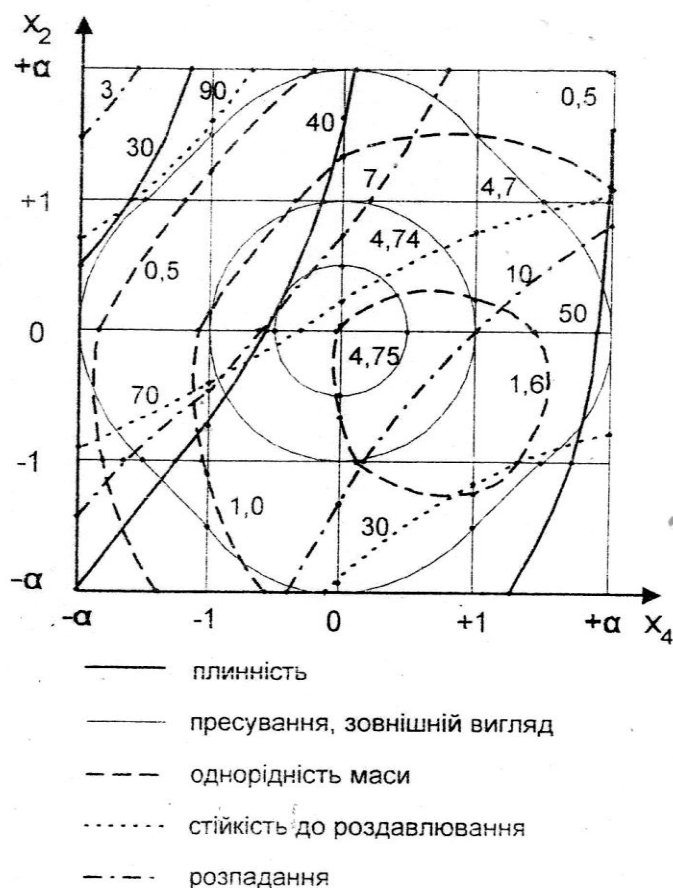
Рис. 3.10. Лінії рівного виходу в системі координат x_2x_4 по результатах перетворених рівнянь регресії
