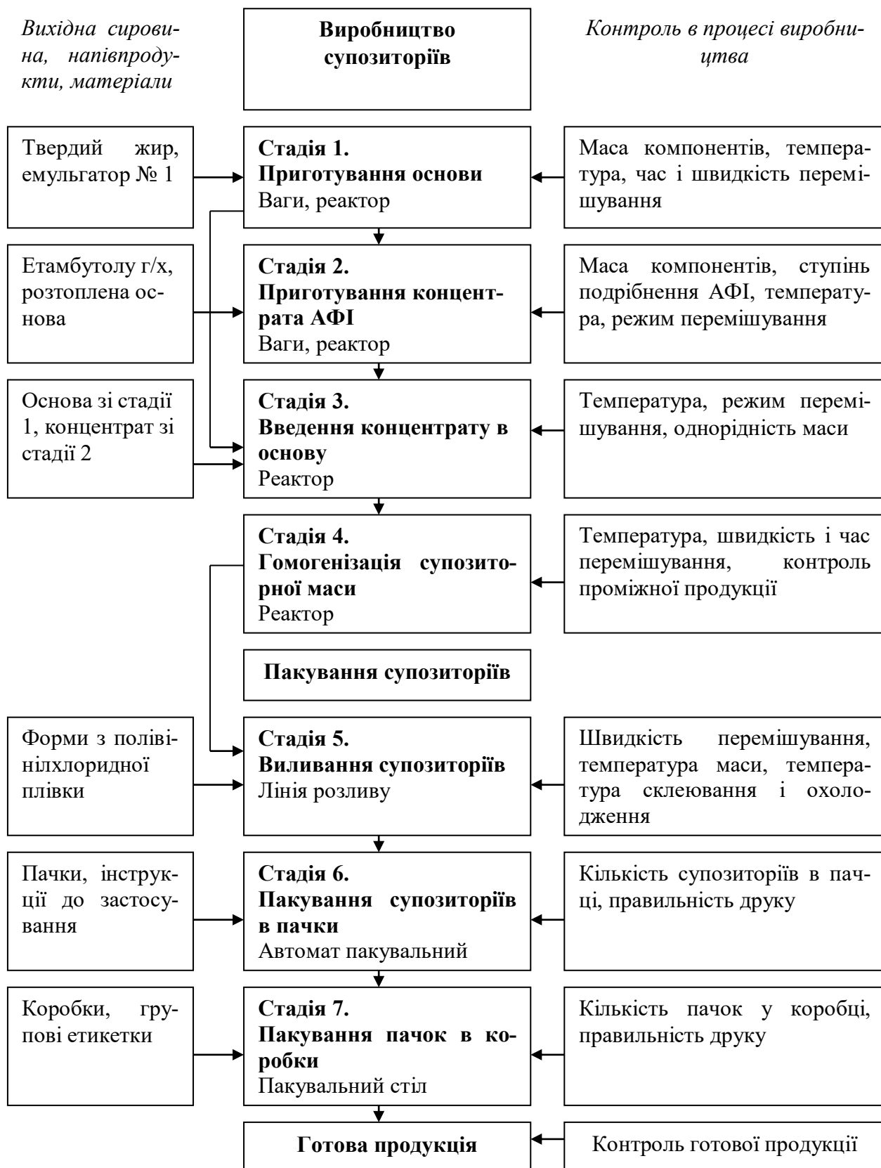
Рис. 5.5. Технологічна схема виробництва супозиторіїв з етамбутолу гідрохлоридом
