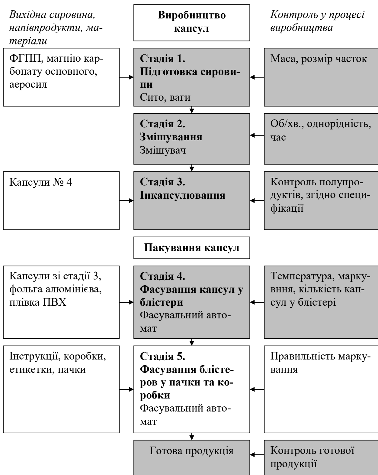
Рис. 2.4. Схема технологічного процесу виготовлення капсул
